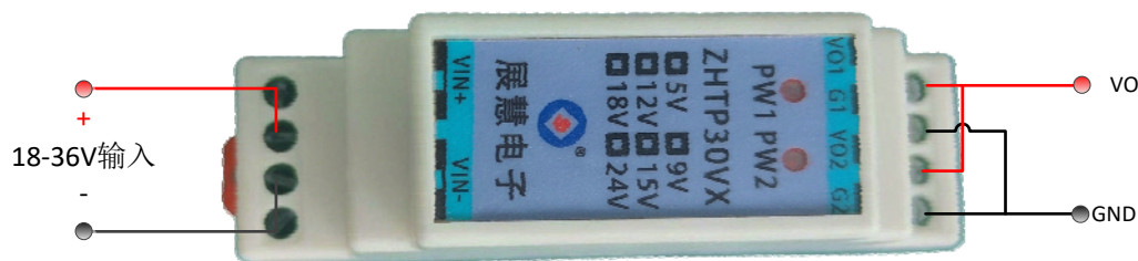
单路Vo输出满功率连接方式
