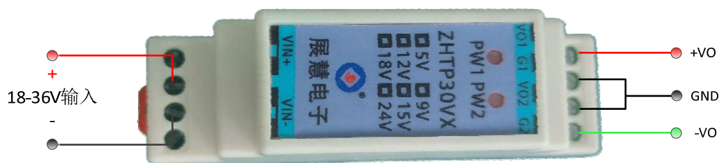
单路正负Vo输出连接方式
